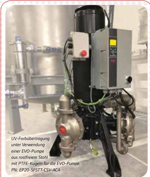
UV-Farbübertragung unter Verwendung einer EVO-Pumpe aus rostfreiem Stahl mit PTFE-Kugeln für die EVO-Pumpe. PN: EP20-SFSTT-CSV-ACA
